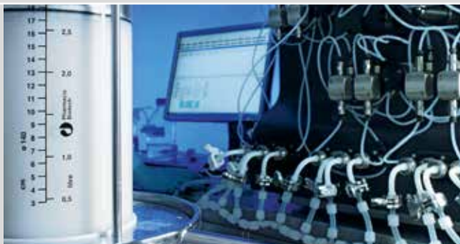
Prozesschromatographieanlage zur Aufreinigung von bispezifischen Antikörperfragmenten.
