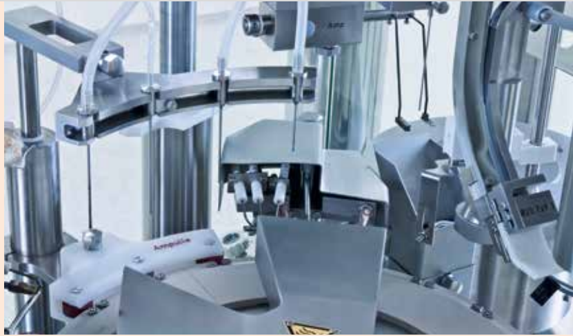
In der Abfüllanlage können kleinvolumige Flüssigarzneiformen in Vials und Ampullen in kleinen Chargengrößen steril und maschinell abgefüllt werden. (Bild mit freundlicher Genehmigung der Robert Bosch GmbH.)
