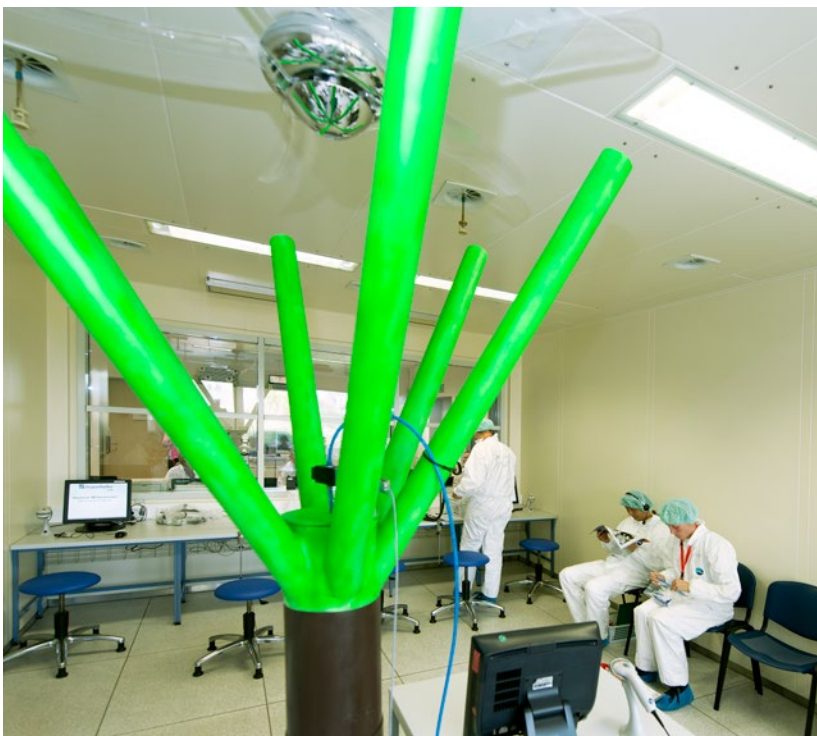
Die Hausstauballergen-Partikel werden im Allergenprovokationsraum mithilfe einer Vorrichtung, die an eine grüne Palme erinnert, gleichmäßig im Raum verteilt.
